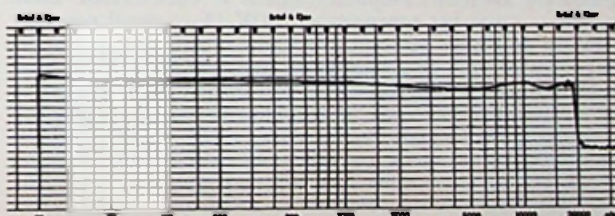
Fig. 2. Weergeefkarakteristiek opgetekend met peilschrijver (ordinaat: 2 dB/verdeling.)
